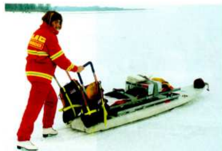
Eisrettungsschlitten aus Aluminium (- der Retter auf dem Bild ist nicht gesichert !!)
