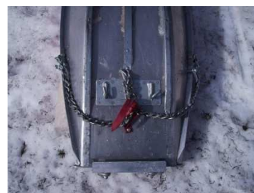
Unterseite mit Kufen; Bremskette ist vor dem Einsatz auf dem Eis zu entfernen
